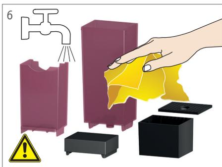
**7** Retirer la fiche réseau de la prise. Ouvrir le levier et nettoyer l'appareil de l'extérieur à l'aide d'un chiffon humide. Ensuite, refermer le levier complètement et replacer tous les récipients dans l'appareil.
