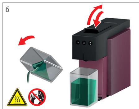
**7** Druk opnieuw op de knop "Grote kop" om het apparaat te spoelen met vers water (geen capsule in het compartiment plaatsen!). Herhaal deze handelingen tot er zuiver water uit de uitloop komt.
