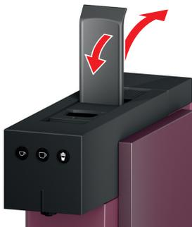
**2** Vider le réservoir d'eau, le replacer vide dans l'appareil et placer un récipient collecteur qui est approprié pour une eau très chaude sous le bec.
